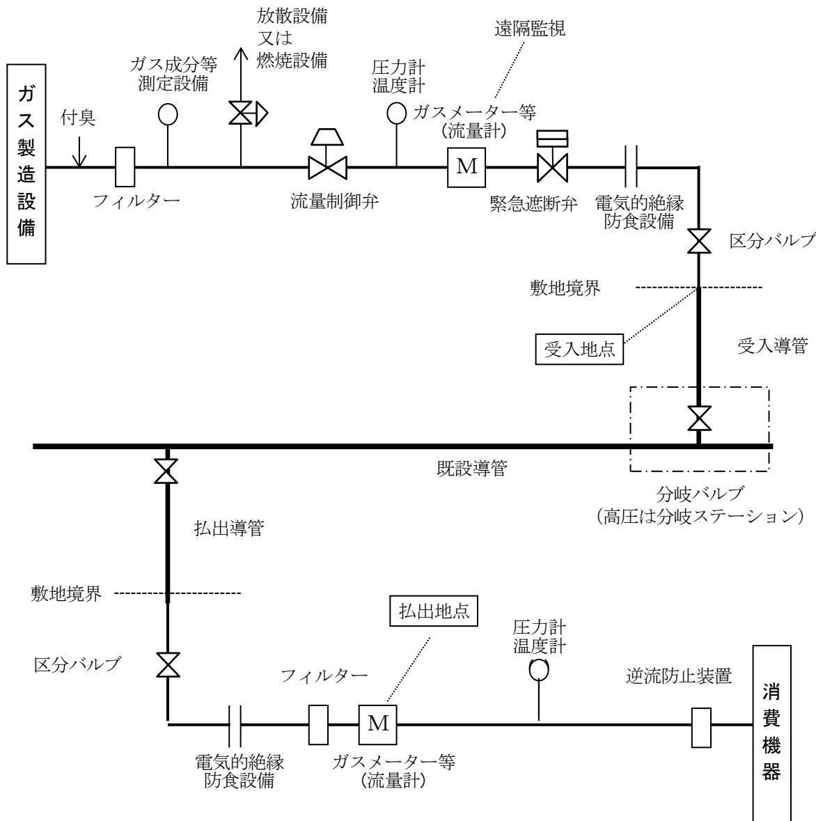
注：上図は概念図として参考に図示したものです。ガス製造形態や受入及び拠出地点の位置等による差異が大きいため、詳細は個別に協議させていただきます。
